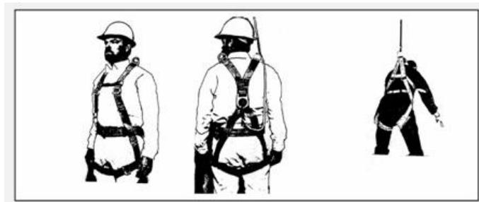
El arnés industrial de cuerpo completo o arnés de sujeción completa del cuerpo, es parte de un sistema o equipo de protección para detener la caída libre de una persona, siendo su uso obligatorio para todo el personal que trabaje en altura a 1,80 metros o más.
